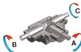
Обороти на конструктивната форма тип 30 ТИП 30 конструктивна форма обороти
