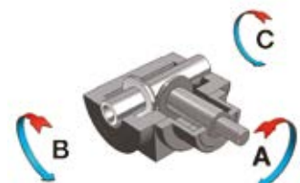
Обороти на конструктивната форма ТИП 4 ТИП 4 конструктивна форма обороти
