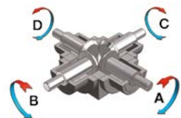
Обороти на конструктивна форма тип 32 Конструктивна форма обороти тип 32
