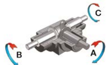
Обороти на конструктивната форма тип 28 ТИП 28 конструктивна форма обороти
